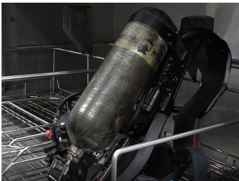
Bild 1 och 2. Smutsig och sotig andningsapparat samt del till bärställ innan diskning
